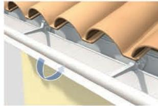
Yağmur oluğu kelepçelere takıldıktan sonra, sağa-sola kaydırılmalı ve olası hizasız kelepçelerden dolayı kasma olup olmadığını kontrol edin.
