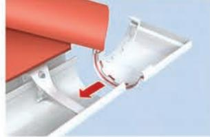
Köşe parçasının dişli kısmına ve açık kısmına kesintisiz şekilde iki şerit yapıştırıcı sürün ve oluğu sonuna kadar iterek yapıştırm.
