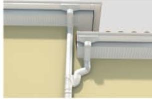
Boruyu aynı cephede yana kaydırmak için "yandirsekt" kullanın. Yanyana iki boruyu birleştirmek için "hazneli çatal" kullanın.
