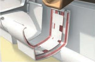
Ek parçasının her iki yanındaki dişli ve düz kısımlara kesintisiz şekilde ikişer şerit yapıştırıcı sürün ve oluğu sonuna kadar iterek yapıştırın.
