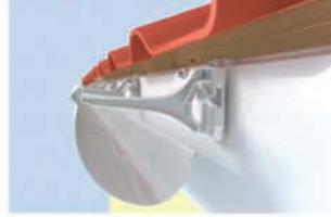
Eğer gizli kelepçe kullanıyorsanız; ilk önce oluğu kelepçelerin ön uçlarına yerleştirin sonra oluğun arka kısmını alttan yukarıya doğru bastırarak kelepçelere klipsleyin.
