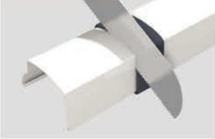
Yağmur oluğunu bir kılavuz yardımıyla düzgünce kesin. Kesim çapaklarını zımpara ile temizleyin.
