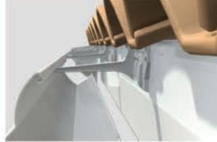
Yağmur oluğunu kelepçelerin ön uçlarına yerleştirdikten sonra, bir döndürme hareketi ile alttan yukarıya doğru bastırın. Böylece yağmur oluğunun arka kısmında kliplenerek kelepçelere oturur.
