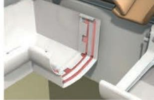
Köşe parçasının dişli kısmına ve açık kısmına kesintisiz şekilde iki şerit yapıştırıcı sürün ve oluğu sonuna kadar iterek yapıştırın.
