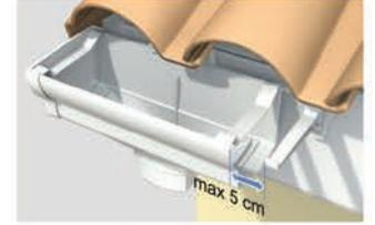
Oluğun rahatça genişleme hareketini yapabilmesi için, iniş haznesi ile ilk kelepçe arasında 5cm mesafe bırakın.
