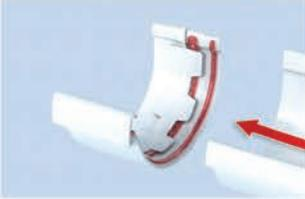
Ek parçasının her iki yanındaki dişli ve düz kısımlara kesintisiz şekilde ikişer şerit yapıştırıcı sürün ve oluğu sonuna kadar iterek yapıştırm.
