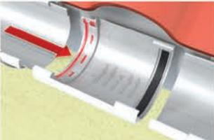
Dilatasyonlu ek parçasının bir kenarındaki dişli ve düz kısımlara kesintisiz iki şerit yapıştırıcı sürün ve oluğu sonuna kadar iterek yapıştırm. Çentalı taraftaki oluğu yapıştırmadan direk dilatasyon parçasının içine doğru sürün.
