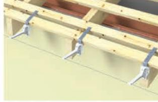
Kelepçelerin direk saçak altına tespit imkanı yoksa, metal kelepçe askısı kullanarak da kelepçelerin montajı yapılabilir.
