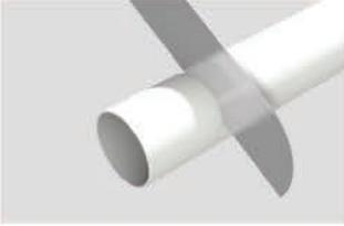
İniş borusunu bir kılavuz yardımıyla düzgünce kesin. Kesim çapaklarını zımpara ile temizleyin.
