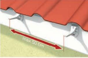
Klasik veya gizli kelepçeleri maksimum 50cm aralıklarla hizalı bir şekilde tespit edin. Kelepçelerin direk saçak altına tespit imkanı yoksa, metal kelepçe askısı kullanarak da kelepçelerin montajı yapılabilir.
