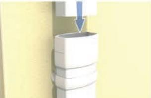
Boru manşonunu alttan gelen iniş borusuna yapıştırın. Üstten gelen iniş borusunu boru manşonuna yapıştırmadan serbestçe yerleştirin. Bu noktada boruların rahatça genişlemesi için bir miktar boşluk bırakın. Her boru manşonunun altına muhakkak bir kelepçe tespit edilmelidir.
