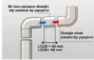
Dirsekleri dişi soket üste, erkek soket alta gelecek şekilde birleştirin. İki dirseği direk birleştirmek için aralarına bir boru parçası koyup yapıştırın. LG28 için 46mm, LG38 için 48mm
